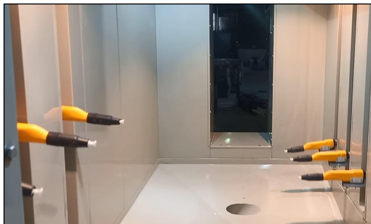
تصویر ۸. نمونه ای از آرایش تپانچه های اتوماتیک پاشش پودری ELCOAT
