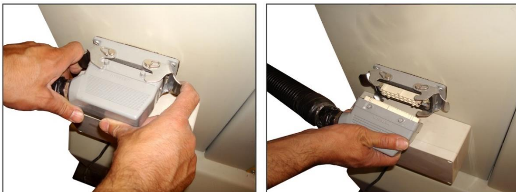
تصویر ۹. اتصال سوکت های برق سیستم اتوماتیک پاشش پودری ELCOAT
