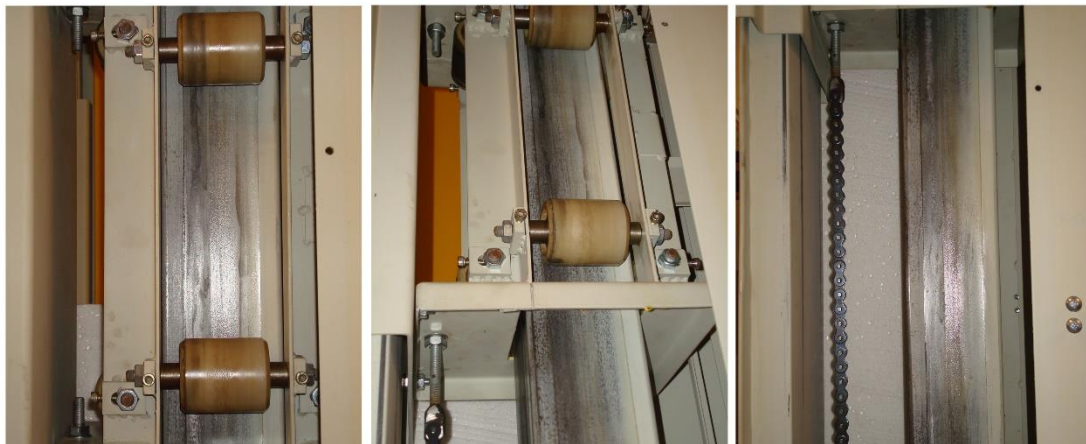
تصویر ۵. حرکت غلتک‌ها در امتداد ستون مرکزی داخل دستگاه ربات پاشش پودری ELCOAT
